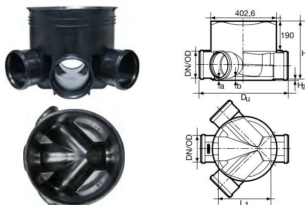
Šachtové dno z PP včetně těsnění – typ II pravý i levý přítok
