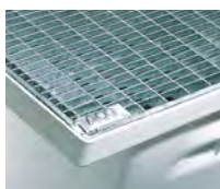
Oka 30 x 10 mm pochozí do 1,5 kN, pojezdny do 9,0 kN. Ideální pro chodníky a terasy.
