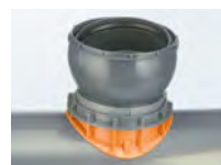
Connex-odbočka DN/OD 160/200 na Connex troubu, otvor 200 ± 1 mm
