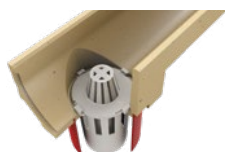
Žlab se spodním odtokem DN 100 lze dovybavit pachovým uzávěrem se sítím hrubých nečistot.
